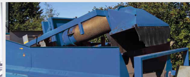
Séparateur aéraulique sur la table des grossiers
