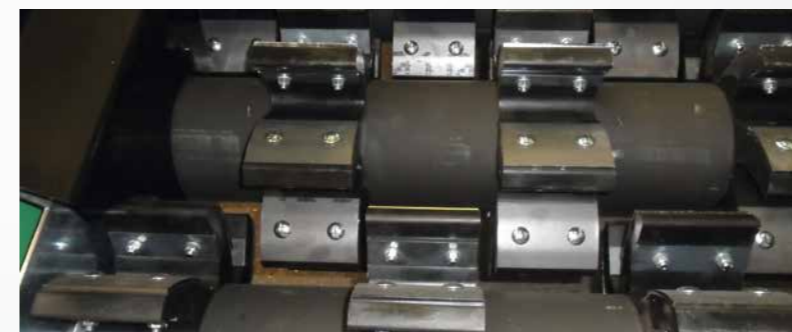
Étoiles de criblage renforcées en polyuréthane
