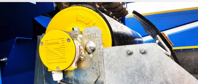
Entraînement électrique du tapis convoyeur
