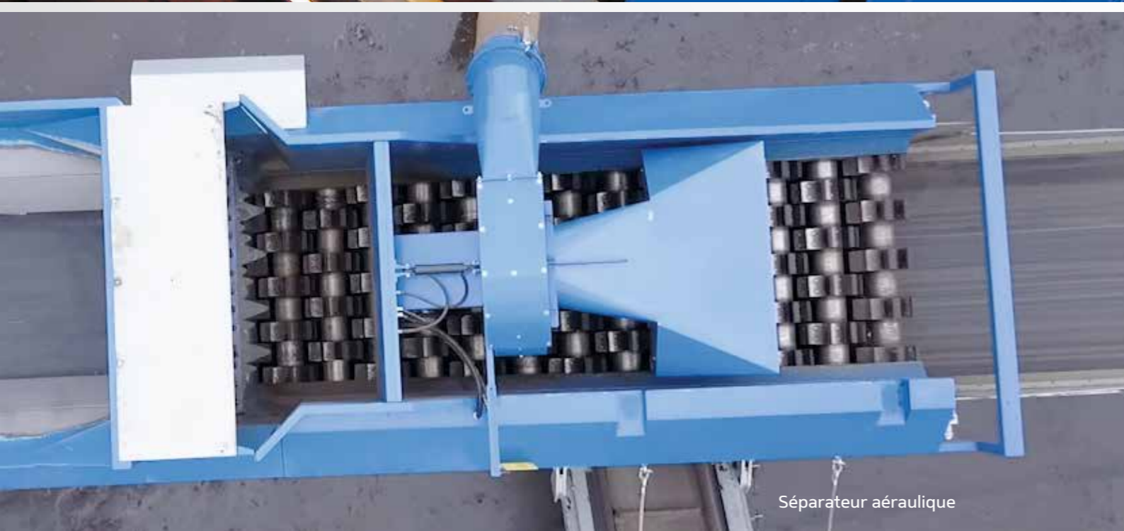
Système d'entraînement à rouleau cranté
