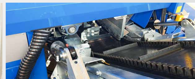
Tapis convoyeur des grains fins monobloc
