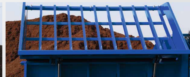
Grille basculante de trémie
