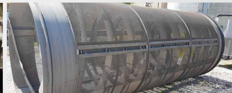
Trommel porteur avec segments en grillage
