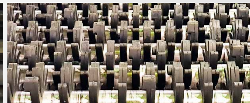
Étoiles de criblage en caoutchouc
