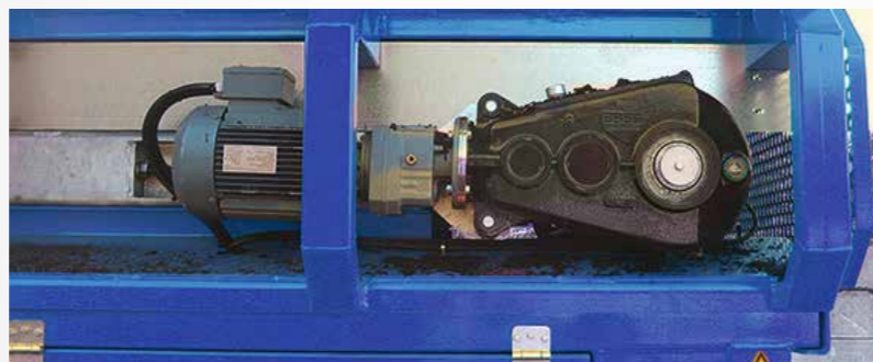
Entraînement électrique de la trémie
