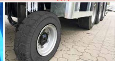
Dispositif d'avancement - permet une avance autonome de la machine grâce à un équipement radio (uniquement pour semi-remorque)
